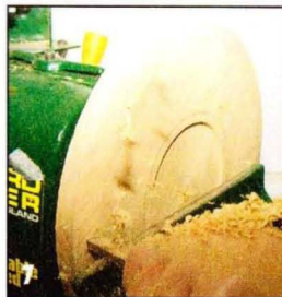
Теперь всё внимание переносят на обработку нижней сферической стороны большой тарелки.
