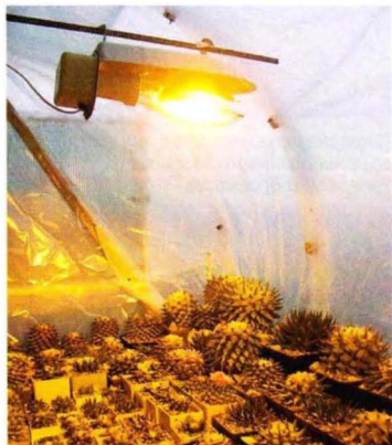
Натриевая дуговая лампа даёт сильный световой поток, но имеет сложную систему поджига. Спектр обычных ламп имеет выраженный пик в жёлтой части. Спектр же специальных ламп для растений имеет второй пик в красной части.
