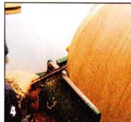
...а затем протачивают внешнюю кромку.
